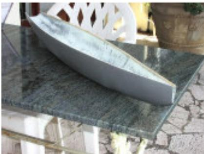
per gli elementi del radiocomando. Si ricorda che questo modello AC100 ha una lunghezza al galleggiamento di 850mm.
